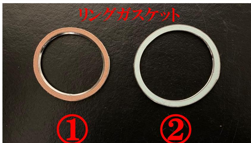
①リングガスケット(小)を使用。ボルトは純正を流用。
