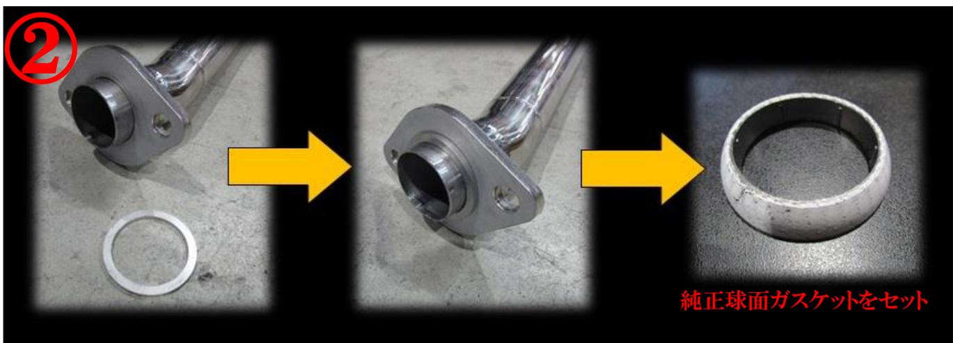
①付属のリングガスケットを使用。ボルトは純正品を流用。
