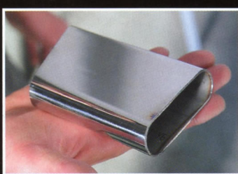
中間からサイド管へ分岐させているが、通常の丸いパイプを通すには腹下のクリアランスが足りない。そこで、左のような潰して平らにしたような特殊なパイプを使ってサイド管へ繋いでいる。「50φのパイプと同程度の排気を通すことができます。腹下に余裕のないVIPならではの技。
