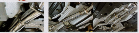
膨張管は腹下に落ちよう、オフセットして流線。故に腹下はフラットなまま。
