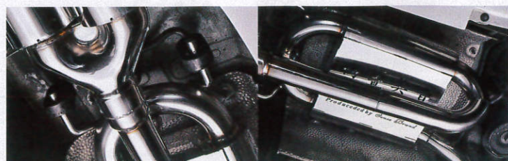
もちろん専用のステーも独自開発。サイレンサーには、ブランド名をアピールする切り文字をレーザー加工で入れる。
