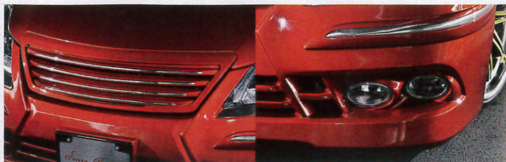
グリル下から自然に通したスピンドルライン。左右にせり出すラインとのバランスを考へて、フォグの間隔を短縮させた。
