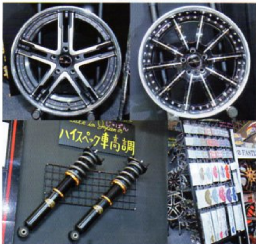
新作ホイールは5本と10本のスポーク系。直線基調の硬質なデザインが今っぽい。車高調は減衰力調整付きのフルタップ式。極低フォルムを実現可能だが「車検対応なのも自慢です」。ステッカーも多数発表。
