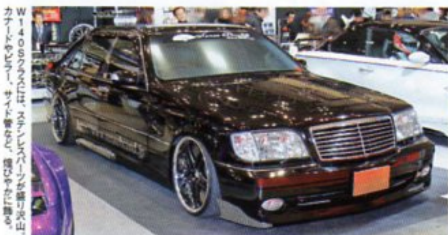
新作ホイールは5本と10本のスポーク系。直線基調の硬質なデザインが今っぽい。車高調は減衰力調整付きのフルタップ式。極低フォルムを実現可能だが「車検対応なのも自慢です」。ステッカーも多数発表。
