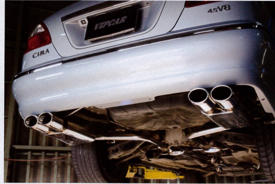
↑材質にSUS304オールステンレスを使用し、フロントパイプ、鏡面仕上げで、フロントアップした時のインパクトも大だ ↑タイコ部分もきっちり取まる。さらに競技用モデルのフルストレートタイプも用意されている ↑片側出しから左右出しに変更できるオリジナルリアピース。ステンレスならではの輝きもポイント。マフラー音も選択でき、ジェットルな音を楽しめる
