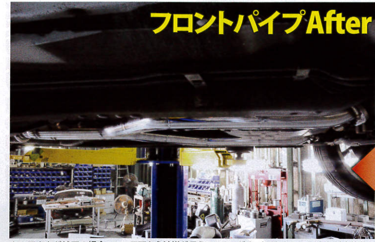
↑写真右が純正の場合、フロア下から触媒が見えているのがくっきりわかる。写真左が交換後。フロントパイプの底上げ幅は最大で約50mm。その違いは見た目にもハッキリわかるはず
