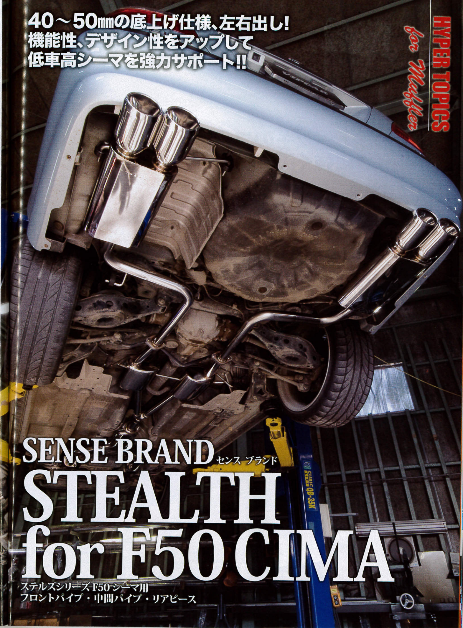
↑中間パイプを強化ブッシュで吊り下げれば、しっかりとフロアよりも上の位置に固定される ←ワイド感あふれる両側出しマフラー。デモカーのリアピースは「クリスティー」(センター/リア共にタイコつき)。 価格 21万2100円
