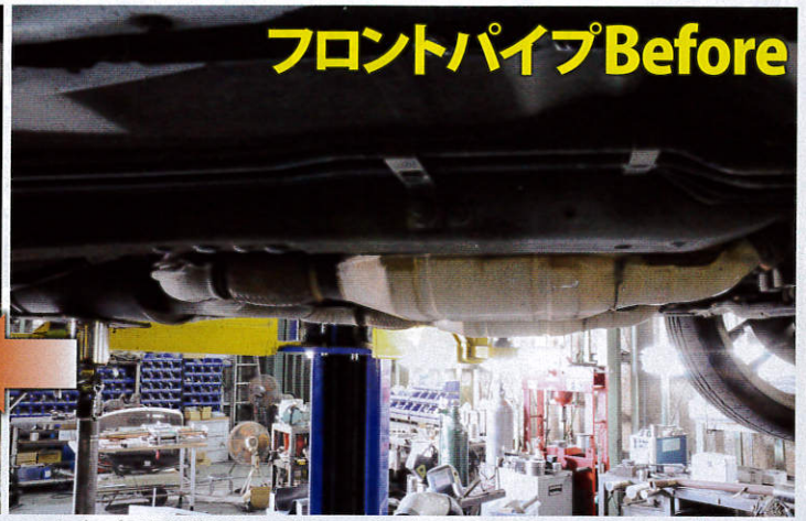
↑写真右が純正の場合、フロア下から触媒が見えているのがくっきりわかる。写真左が交換後。フロントパイプの底上げ幅は最大で約50mm。その違いは見た目にもハッキリわかるはず
