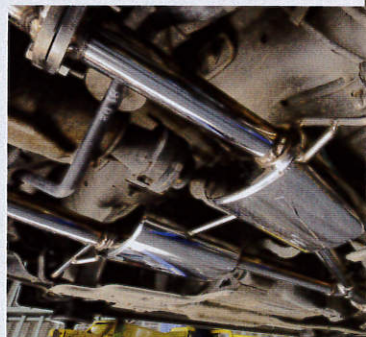
↑中間パイプを強化ブッシュで吊り下げれば、しっかりとフロアよりも上の位置に固定される ←ワイド感あふれる両側出しマフラー。デモカーのリアピースは「クリスティー」(センター/リア共にタイコつき)。 価格 21万2100円
