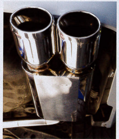
↑材質にSUS304オールステンレスを使用し、フロントパイプ、鏡面仕上げで、フロントアップした時のインパクトも大だ ↑タイコ部分もきっちり取まる。さらに競技用モデルのフルストレートタイプも用意されている ↑片側出しから左右出しに変更できるオリジナルリアピース。ステンレスならではの輝きもポイント。マフラー音も選択でき、ジェットルな音を楽しめる
