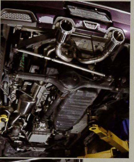
マフラーの構成は、テール部と中間部の2分割になっている。 後方で2つに分岐、曲げの角度や分岐の処理が美しい。
