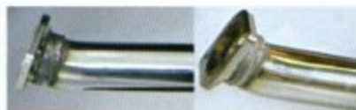
↑ローダウン車に対応させるべく、フランジの下部を削ってフラットにしているのもポイント
