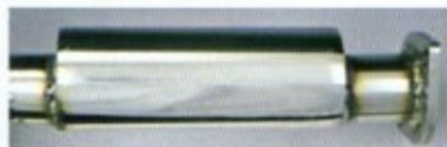
↑パイプとタイコの位置をオフセットして地面とのクリアランスをかせぐ
